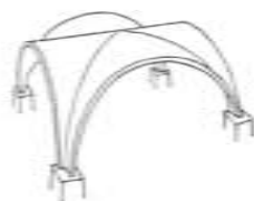
Ilustración 27. Esquema de una bóveda de aristas de base cuadrada.
