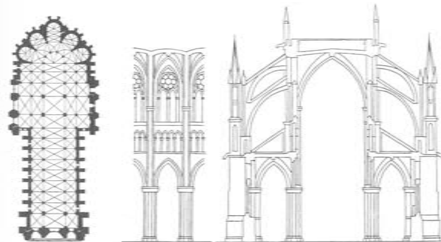
Ilustración 63. Planta, alzado de un tramo y sección transversal de la catedral de Reims. Es un ejemplo de gótico radiante en el que la ausencia de tribuna y unos arbotantes muy alargados han permitido la iluminación prácticamente sin obstáculo de la nave central.
